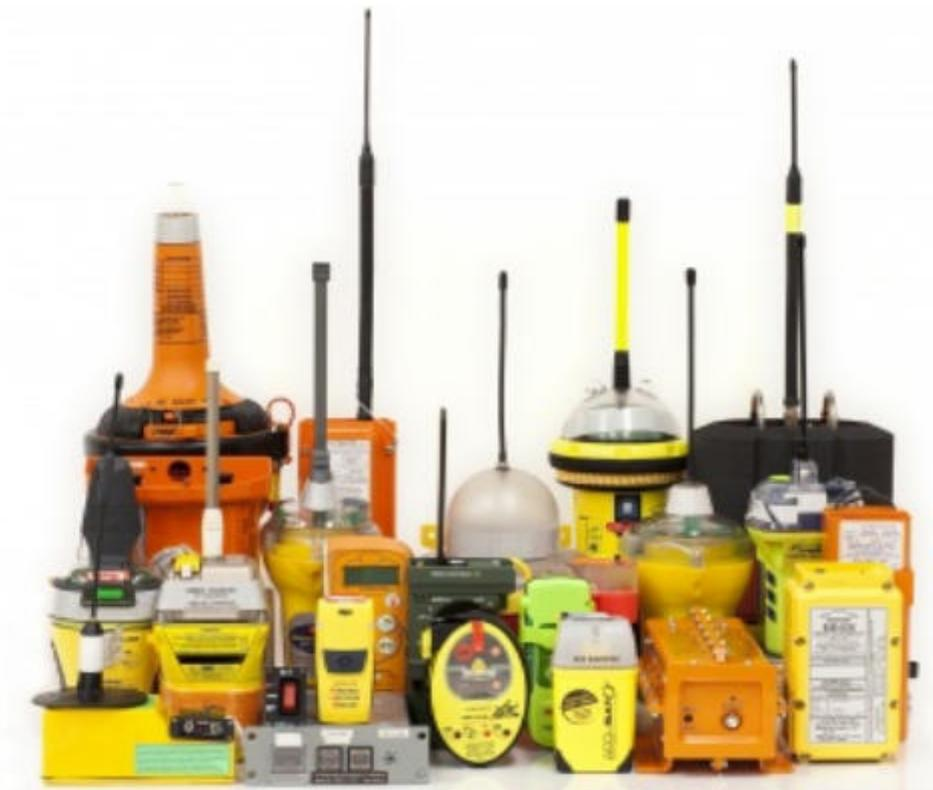
Они передают сигнал на частоте 406 мгц, сигнал принимается спутниками несущими ретрансляторы КОСПАС-САРСАТ и передается обратно на землю на частоте 1544 МГц.
