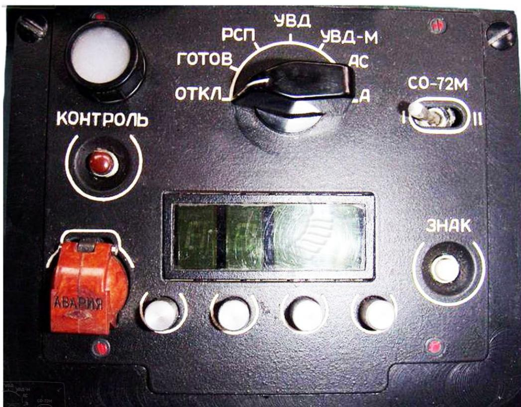
*Ответчик УВД. Под дисплеем ручки установки кода ответчика.*
