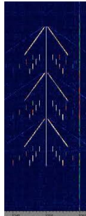
Мощный АМ сигнал нелинейно взаимодействуя с ионосферой создавал в ней токи с частотой модуляции.
