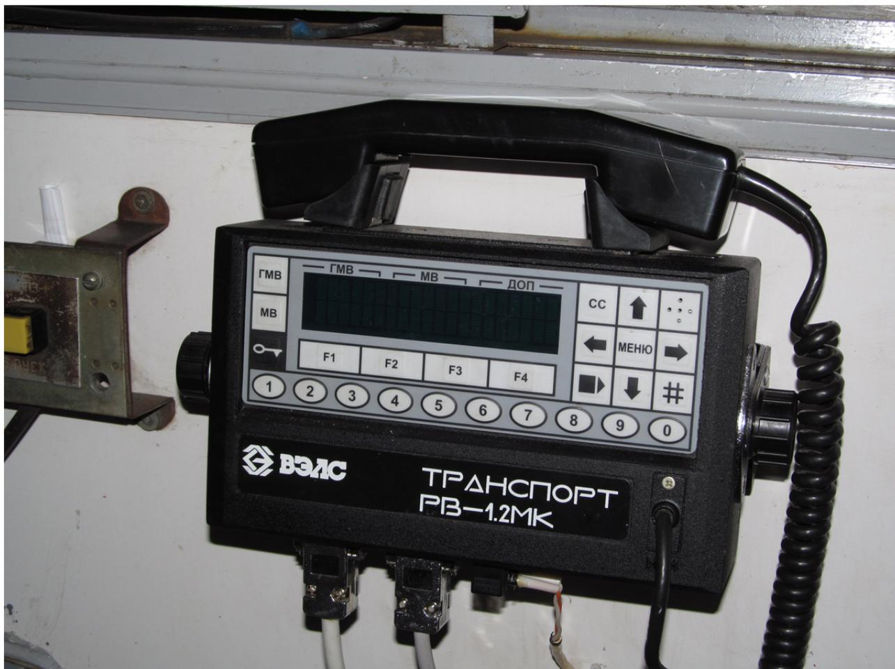
Поездная радиосвязь осуществляется на частоте 2130 кГц (2.13 МГц), модуляция ЧМ. Связь осуществляется с помощью длинной двухпроводной линии растянутой вдоль путей на столбах.
