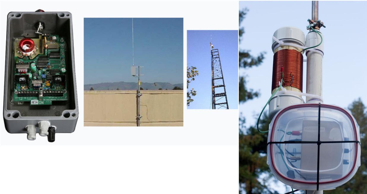
Т.к. длина антенны ограничена законодательно а передатчик очень маломощный то многие продающиеся в америке подобные устройства просто устанавливаются прямо под антенну. Радиус действия такого передатчика — около мили. Есть аналогичные поправки касающиеся вещания на FM (LPFM) и ТВ (LPTV).
